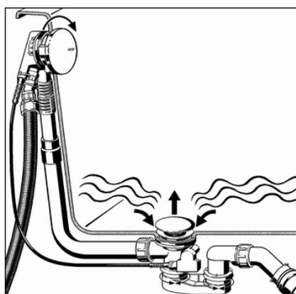
■ Die Drehrosette nach rechts drehen.
