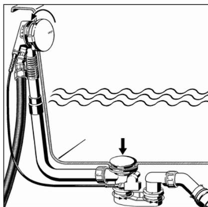
■ Die Drehrosette nach links drehen.
