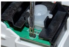
Testen Sie das Funktionieren indem Sie ein Überbrücken der zwei Kontakte vornehmen. Die Öffnungsklappe sollte dann zwei mal öffnen und schließen.
